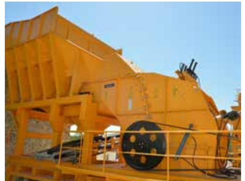
SARIÇELİK markası Primer besleme üniteleri daha fazla üretim sağlamak için yüksek mukavemetli çelikler ve yüksek darbeli vibratörler kullanır. Ağır hizmet tipi titreşimli besleyiciler, ağır hizmet tipi gövdeleri ve yüksek darbeli titreşim
