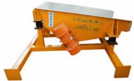
Tekne Besleyicileri ; yüksek kapasitede besleme yapabilmek için tasarlanmış olup, geniş aralıktaki kapasitelerde malzeme dalgalanmasını engellemektedirler. Çalışma eğilimleri aktarılabilecek malzeme ve özelliğine göre 0-15 derece arasında değişmektedir .
