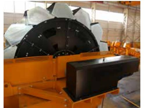
Beton üretiminde temiz kum kullanımının çimento miktarında tasarruf sağlaması hazır beton imalatçılarının yıkanmış doğal kum ve taş kumunu tercih etme sebebidir. Yüksek verimli, düşük maliyet, farklı kombinasyon seçenekleri ile yıkama sektöründe SARIÇELİK lider konumdadır. CSWS serisi yıkama sistemi çökeltme havuzlarına yada su arıtma aşamasına giden değerli
